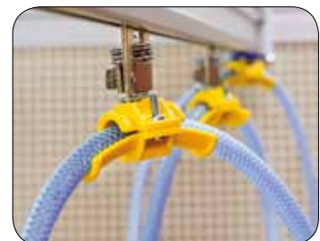
Kabelvagnar hjälper till att hålla ordning på längre kablar och slangar.
