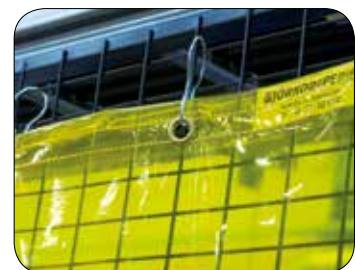
Pärnkrokar används bland annat för att hänga upp ett svetsdraperi på t.ex. ett maskinskydd vid en svetsrobotcell.
