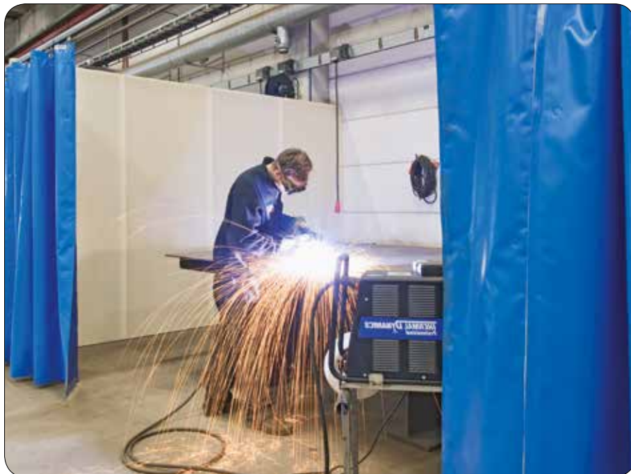
Bullerdämpande draperier och bullerväggar kompletterar varandra för effektiv dämpning.
