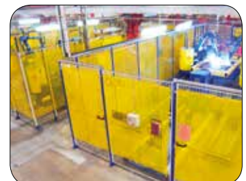
Svetsdraperier går enkelt att hänga på maskinskydd för att skydda mot svetsblänk och stänk.
