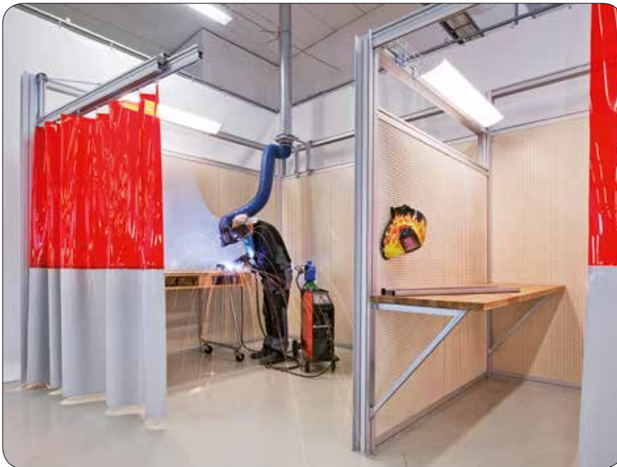
Svetsdraperier tar bort skadlig UV-strålning vid svetsning.
