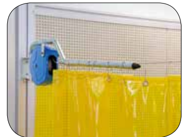
Draperihållare används där överligger ej kan användas, t.ex. vid traverspassering.
