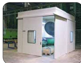
Bullerhus används för att dämpa mycket högljudda maskiner.
