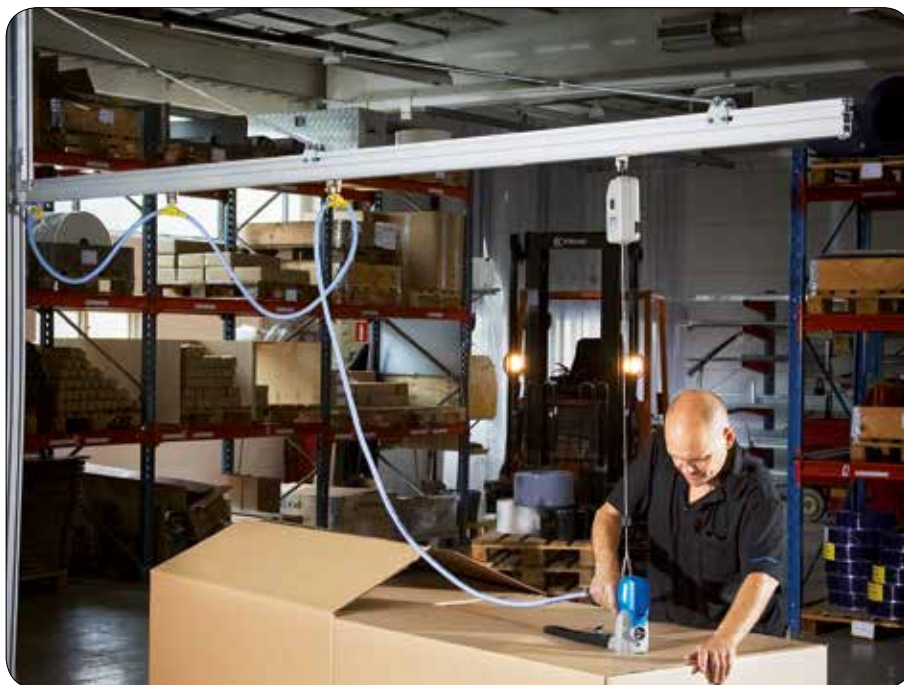
Svängarm med tillhörande balansblock ger ett mer ergonomiskt arbete.
