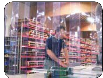
En PVC-ridå inomhus sänker buller samt skyddar mot damm och smuts.
