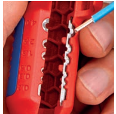
Avisolering av enskilda ledare
