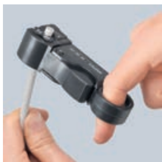
Klippning i tre steg i ett arbetsmoment
