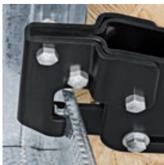
Tången sätts fast på två profilplåtar som skall förbindas
