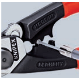
Anpressning av ändhylsan på draglinan
