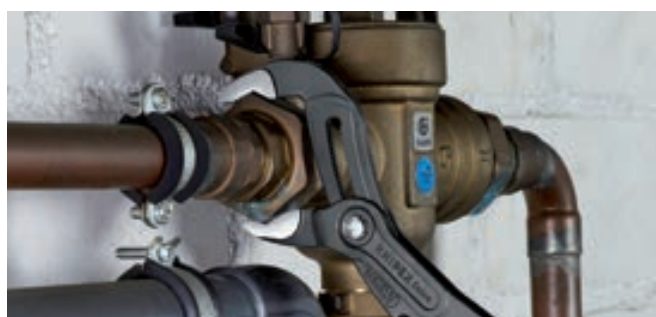
Mot rotationsriktningen förskjutna tänder åstadkommer en självklämmande effekt
