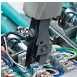
Kabeln kan tryckas in och klippas av i ett arbetsmoment
