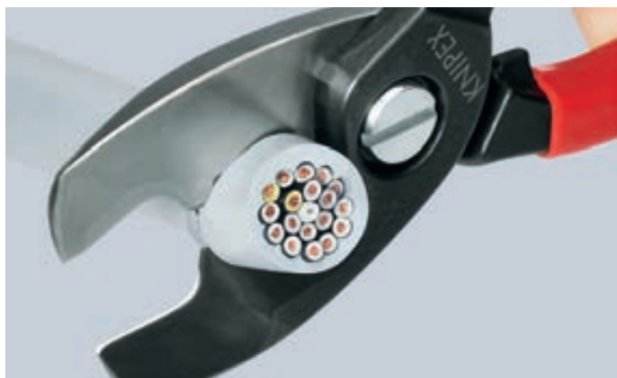
Eftersnitt: Först efter klippning av kabelns mantel i främre profilen klippas ledaren i det bakre klippområdet. Försnitt fram, eftersnitt bak – på det sättet blir det enklare.
