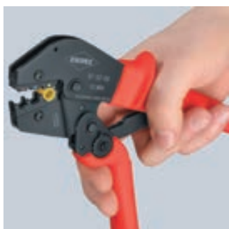
Första steg: drag fram skänkeln med två fingrar tills båda käftarna ligger på det skarvdon som skall pressas
