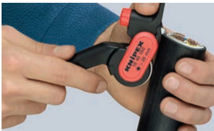
Verktögets fastsättning för längdskärning
