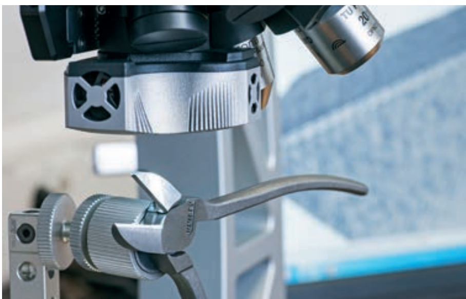
På sidavbitaren mäts skärets form och ytjämnhet exakt med hjälp av det optiska 3D-mätssystemet.
