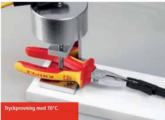
VDE-överdragens greppförmåga har testats med 500 N.
