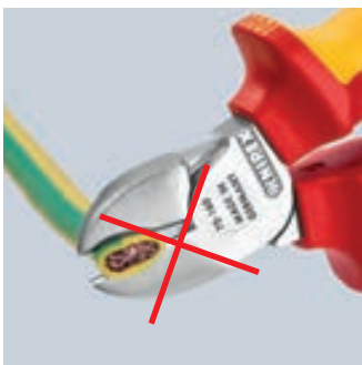
Kabelklippning med sidavbitare: hög kraftansträngning, oexakt snitt, stark deformation och klämning av kabeln
