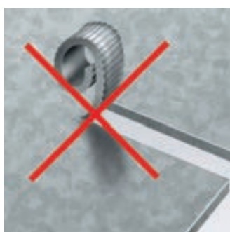
Utklippning utan spånbrytare
