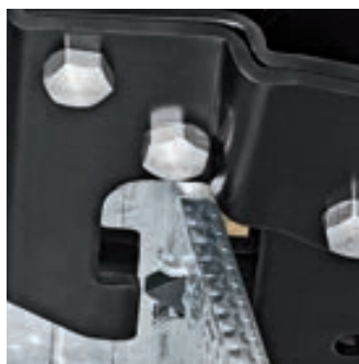
Stansverktyget pressas genom profilplåtarna
