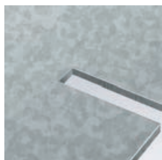
Utklippning och spånbrutning i ett arbetsmoment
