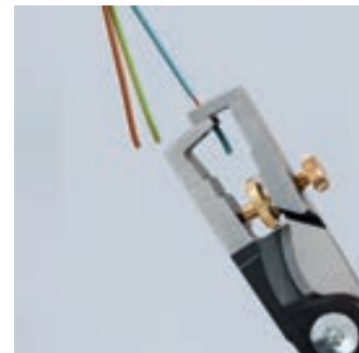
Längdmarkering: Optiska markeringar hjälper vid upprepade avisolering av vanliga längder (11 mm och 16 mm)
