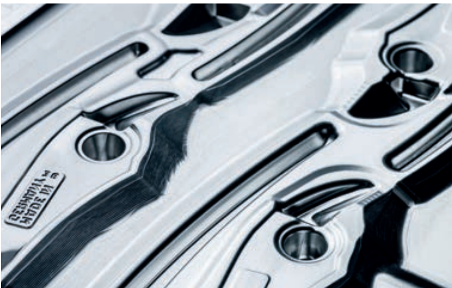
Smidessänke för kraftsidavbitaren med fastsmidd ledaxel.
