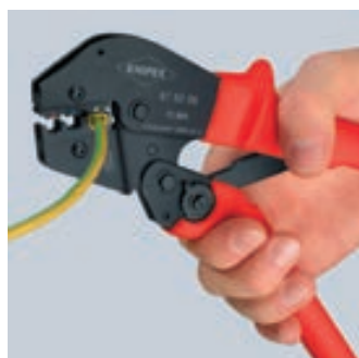
Andra steg: använd nu hela handen för att fortsätta pressningen
