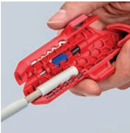
Avmantla en EKLK-kabel
