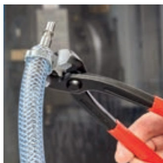
Tätning tryckluftsslang mot snabbkoppling genom pressklack på fronsidan
